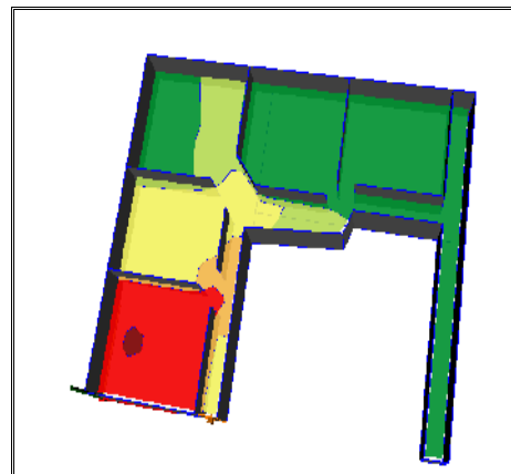
Illustration 4: carte de propagation du bruit - plafond absorbant - logiciel AcousPropa®
